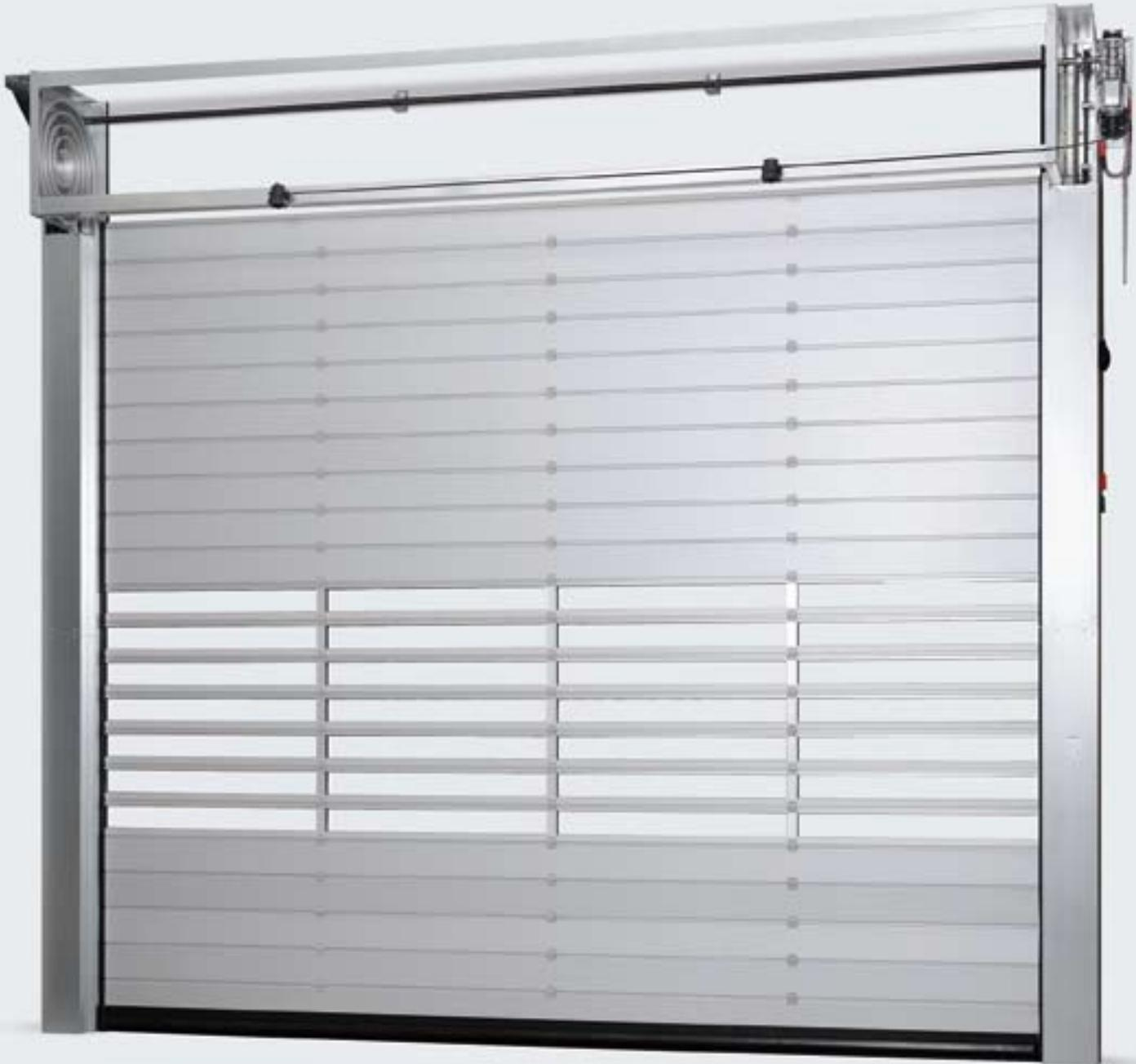
Charakteristisch für das Spiraltor HS 7030 PU sind die elegante Micrograin Oberfläche der feuerverzinkten, doppelwandigen Stahllamellen mit ihrer hohen Wärmedämmung, die schnelle Öffnungsgeschwindigkeit durch die berührungslose Aufrolltechnik und das serienmäßige Sicherheits-Lichtgitter.
