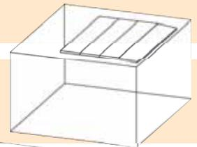
In geöffnetem Zustand hängt das Tor an der Decke, dadurch kann wertvoller Platz links und rechts in der Garage voll genutzt werden
