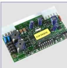
Schleifendetektor für Sicherheit + Impuls für die Erfassung von KFZ, aufsteckbar auf Steuerung 624 BLD
